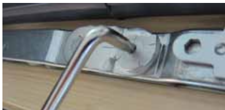
Bočno podešavanje u gornjem dijelu ključem Torx 15
